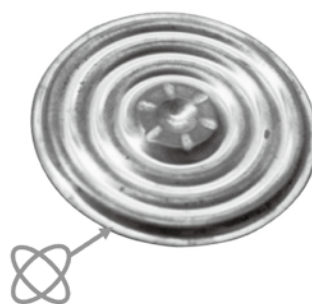
図7 ダイアフラムの溶接(銅合金)
