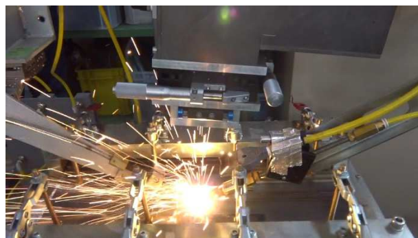
図2. 固体レーザー溶接時のスパッタの比較
