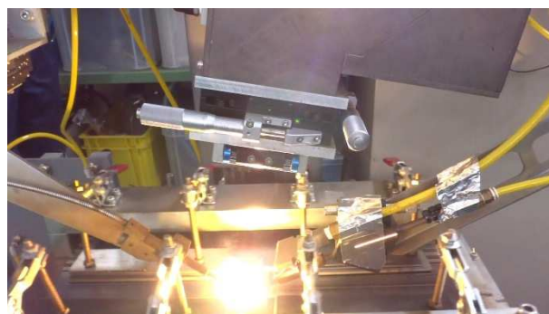
図2. 固体レーザー溶接時のスパッタの比較
